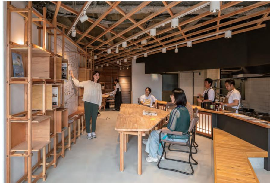
まちと人を編み込むように、規格木材を格子状に配した。ボルト留めジョイントとすることで材の再利用が可能
